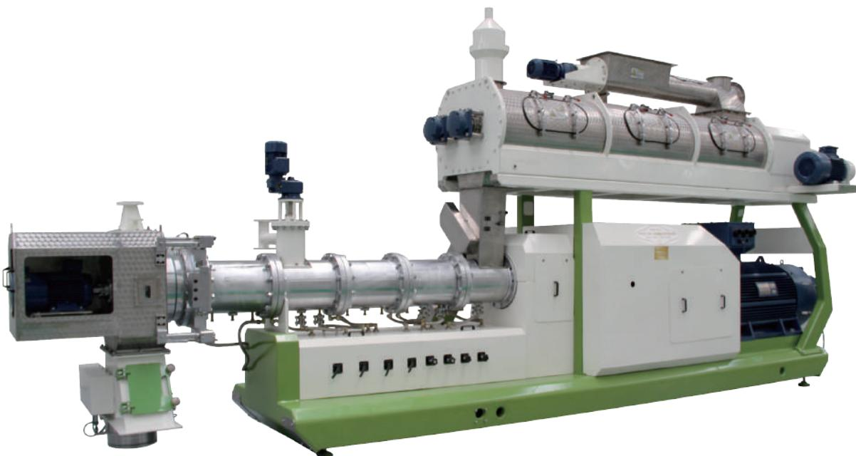
اکسترودر آبزیان دو مارپیچ مدل  $2 \times 130\text{SPHS}$
