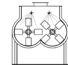
در صورت نیاز می‌توان از سیستم تزریق مایعات استفاده نمود که از چسبیدن مواد به حفاظه جلوگیری می‌کند و میزان پسماند مواد کاهش می‌یابد.
