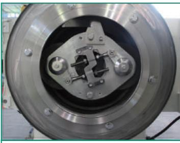
مجهز به سیستم تنظیم خودکار رولر با قابلیت تنظیم فاصله بین رولرهای بدون متوقف کردن تولید و خاموش کردن دستگاه
